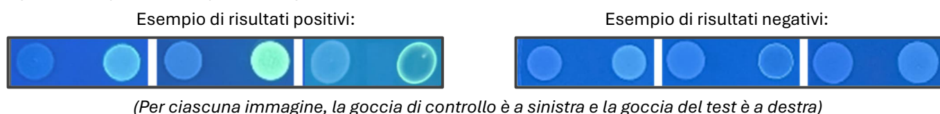
Figura 2: esempio di risultati positivi e negativi visivamente attesi sotto UV 365nm
